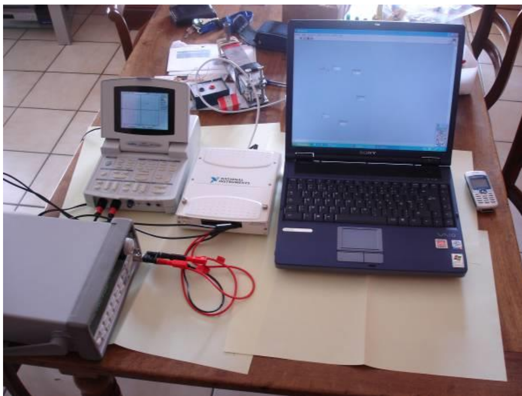
Az első összeállításunk (balról jobbra): a jelgenerátor, az oszcilloszkóp, a National Instruments (NI) DAQ kártya és a komputer. A háttérben látható az aktuális mikroszkóp állvány. Amikor használjuk a mikroszkópot, akkor a padlóra kell helyezni – az asztalon elhelyezve ugyanis túl erős a rezgés
